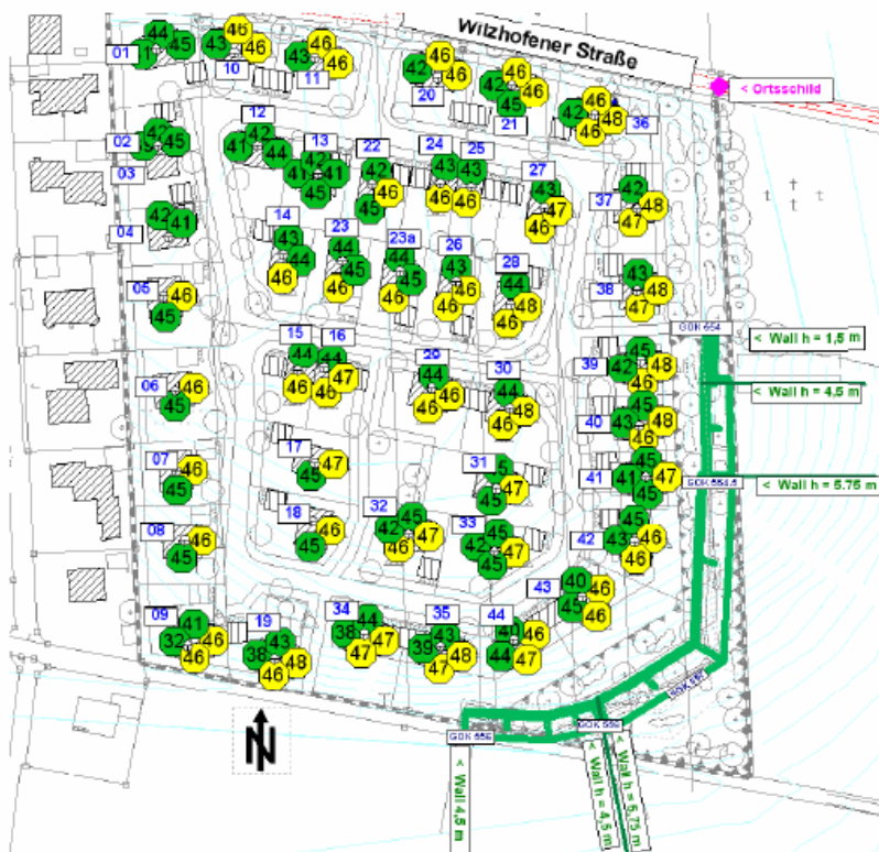
Abbildung 6 Immissionsbelastung im 1.Obergeschoss; Nacht: Orientierungswert WA = 45 dB(A); (Gelb = Überschreitung), Geschwindigkeitsbegrenzung auf der Wilzhofener Straße auf 50 km/h und Wall in der Grünzone
