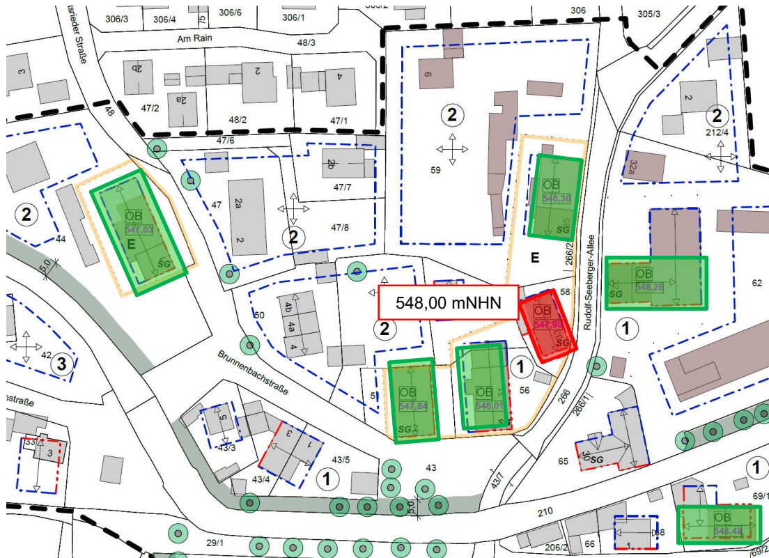
Abbildung 7: Wasserspiegellhöhen an den ortsbildprägenden Gebäuden
